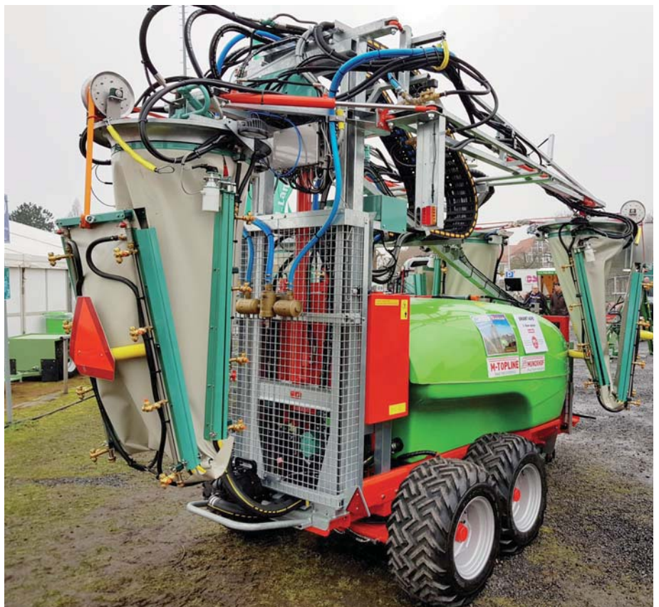
Abb.5:3-Reihen-Sprühgerät Typ 106 mit Air System (VariMAS) der Firma Munckhof
