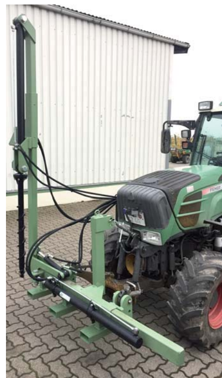
Abb. 3: Anbaurahmen des Parallelbohrers kombinierbar mit Messerbalken für automatischen Baumschnitt
