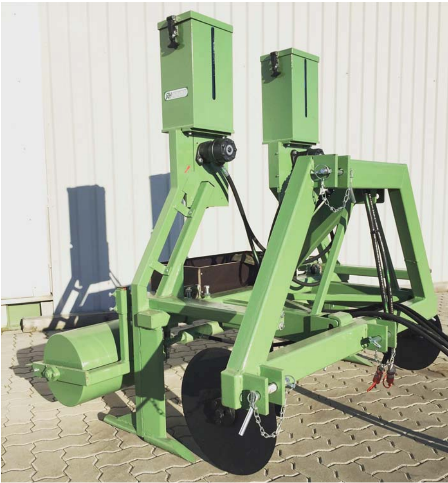
Abb. 4: Beidseitig arbeitender Mäuseköderleger mit hydraulischer Köderzufuhr und Breitenverstellung
