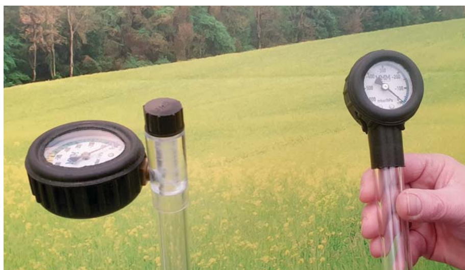
Abb. 5: Links: Sehr schnell reagierendes Tensiometer TX/TXSU, rechts: Herkömmliches Tensiometer
